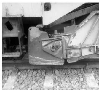
Fig. nr.2: Placa de uzură a plugului frontal spate stânga, fixată corespunzător cu dispozitiv de blocare în caneluri
