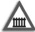
trecere la nivel cu o cale ferată cu barieră sau semibarieră (fig.A41 din SR 1848-1 din 2011)
