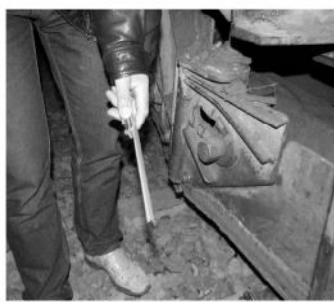
Fig. nr.3: Placa de uzură a plugului frontal spate dreapta fixată necorespunzător cu saibă plată
